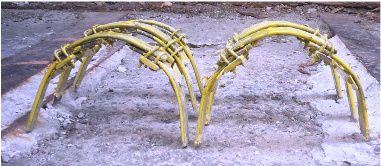
Рисунок 6 – Внешний вид рам после испытаний
